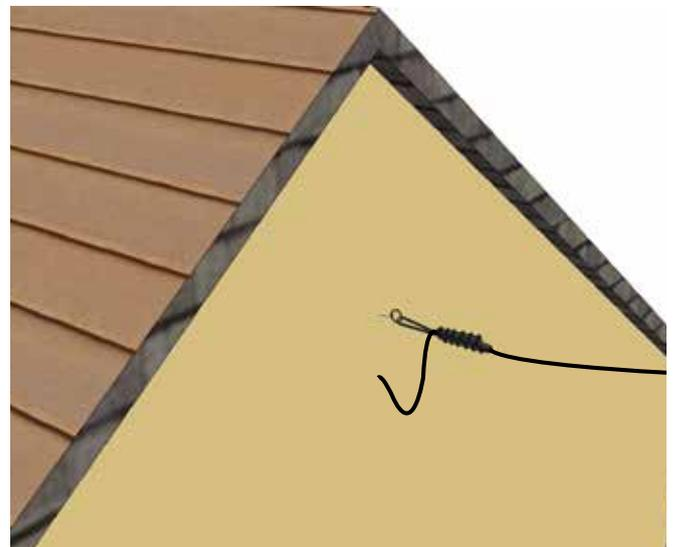
Le câble de branchement est arrimé en façade du logement par une pince d'ancrage de branchement.
