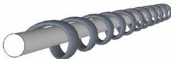
Les vibrations sont absorbées par impact dans la partie lâche
