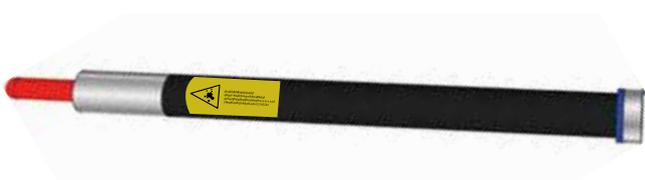
Le localisateur de défaut ou laser rouge est une source de lumière rouge en général présentée sous forme de stylo optique. Il permet de s'assurer de la continuité optique d'un lien et de visualiser les coupures de fibre, les contraintes (macrocourbures), connecteurs défectueux ou épissures défailantes. Sa portée peut aller jusqu'à 7Km.
