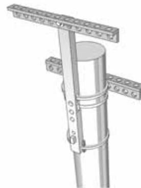
**Sur poteau bois en position latérale par rapport à la traverse existante, boulon traversant + tirefond posé**
